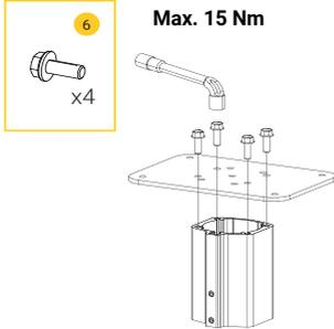
! L'orientation de la platine par rapport au manchon dépend de si on veut une configuration Road ou Area.
