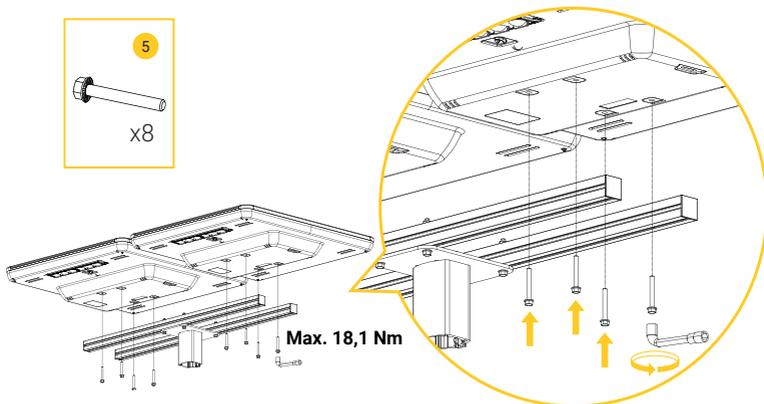
Les vis qui permettront de fixer le manchon au mât doivent avoir leur empreinte vers l'extérieur pour pouvoir serrer à l'étape suivante.
